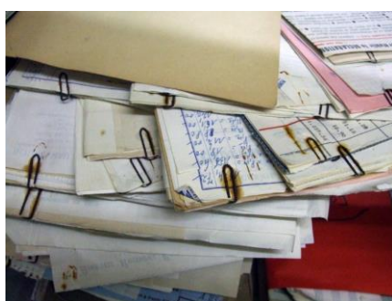
Dégâts causés par l'humidité sur du fer.
